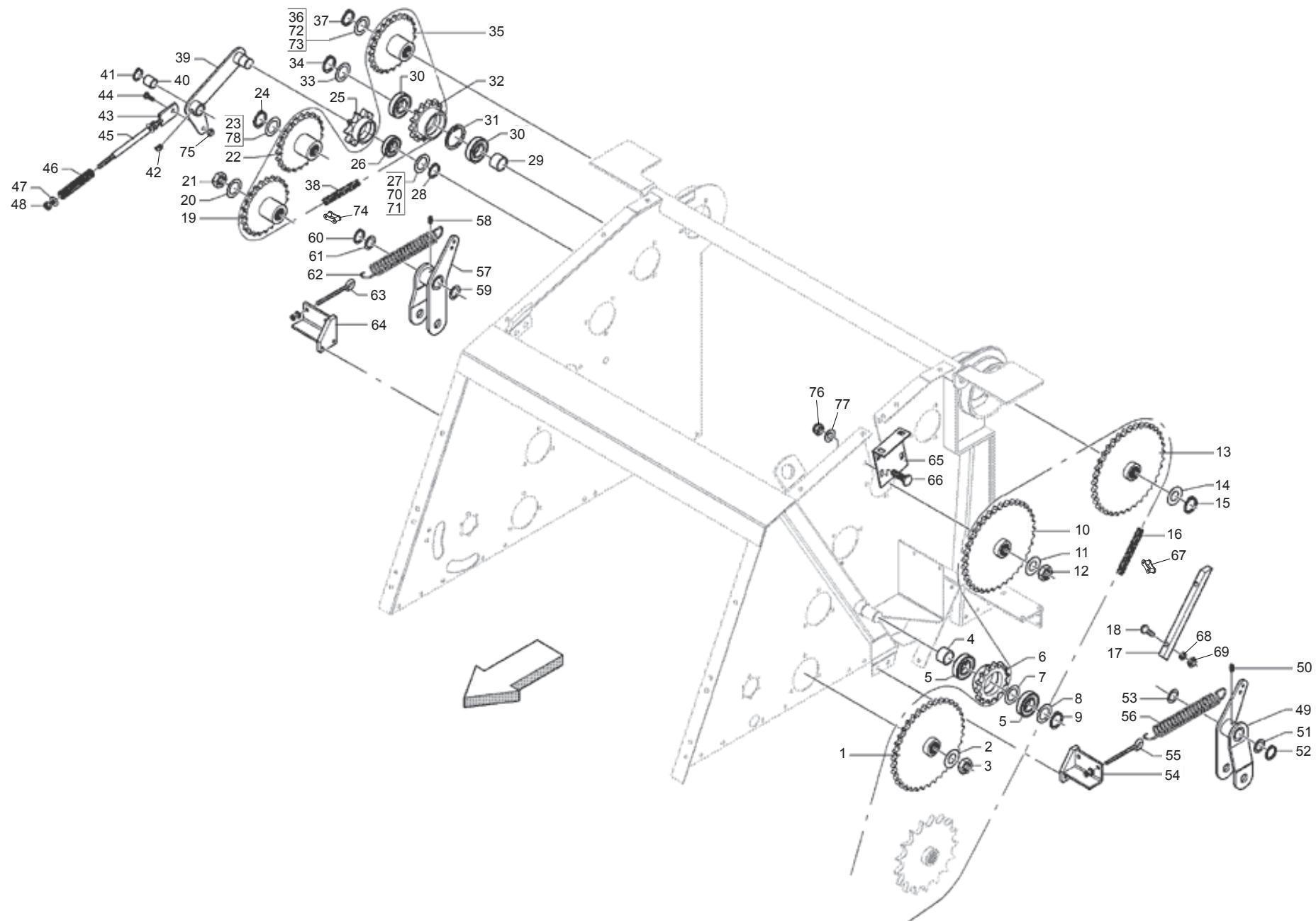
**TELAI SUPERIORE: TRASMISSIONE**
