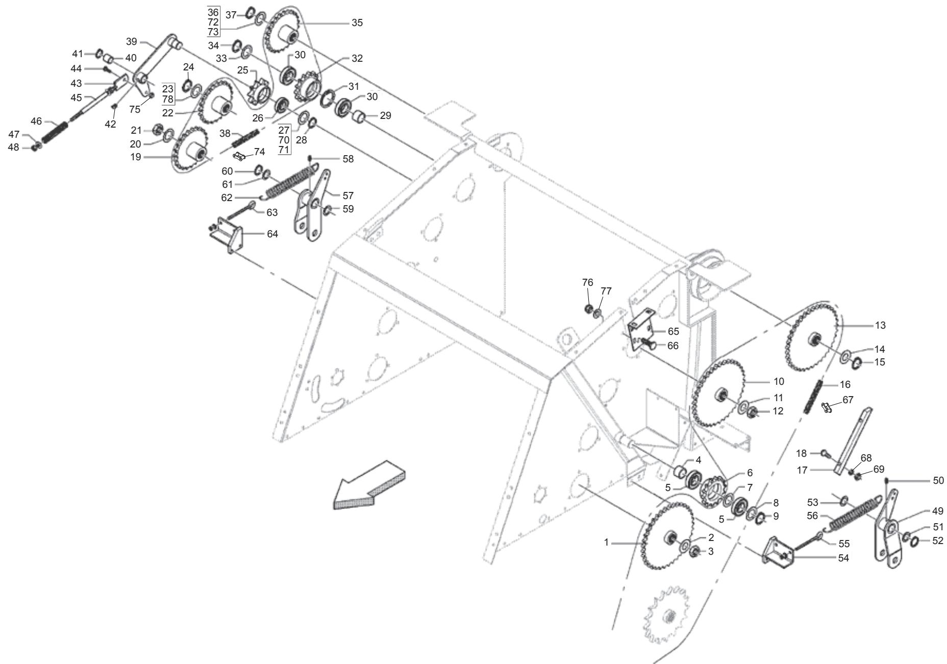
**TELAI SUPERIORE: TRASMISSIONE**
